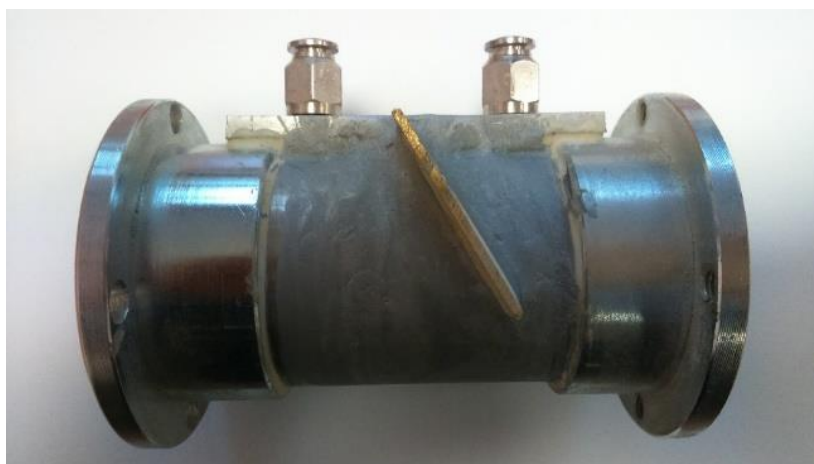
Rys. 1.11. Przepływomierz z kryzą segmentową: a) widok prototypowego przepływomierza przed osadzeniem przegrody - kryzy; b) widok gotowego modułu przepływomierza dla \gamma = 30^\circ ; m = 0,370
